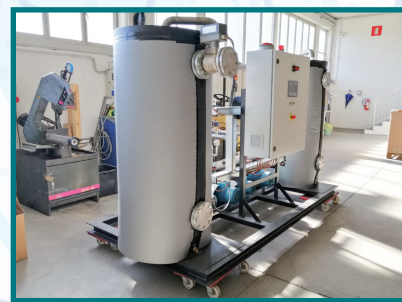
Skid di pompaggio con regolazione automatica per Fonderia di Ghisa, installato in Portogallo.
